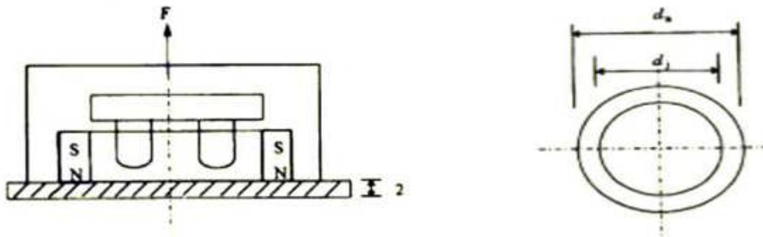
a) 吸力, 磁力线方向: N 极轴线指向多功能电能表; b) 尺寸: 内径  $d_j=13\text{mm}\pm 1\text{mm}$ , 外径  $d_a=28\text{mm}$ (最小值)
